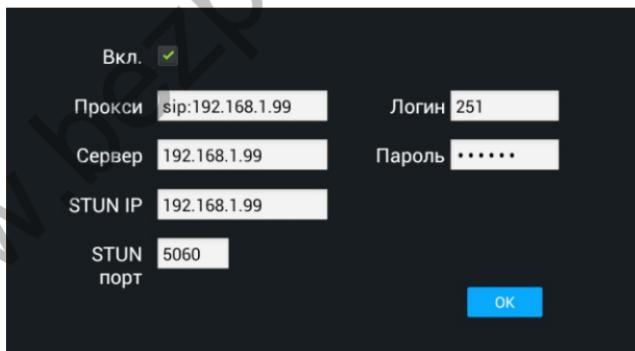
Установите галочку «Вкл» для регистрации на SIP-сервере, либо снимите ее для отмены регистрации на SIP-сервере. «Прокси» - IP адрес SIP-сервера; «Область» - IP адрес области SIP-сервера; «Stun IP» - IP адрес STUN и «Stun порт» - порт STUN. В поля «Логин» и «Пароль» - впишите имя пользователя и пароль от своего аккаунта.
