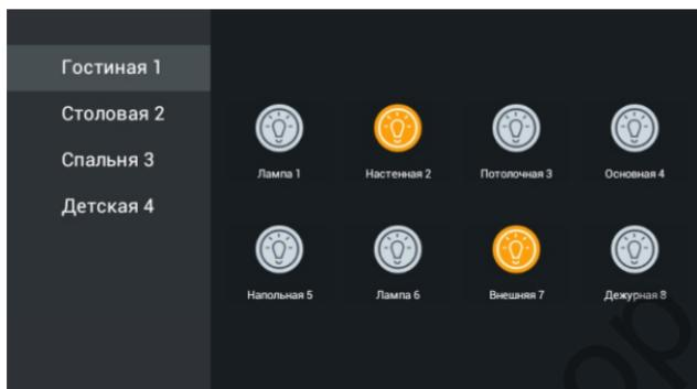
Для управления светом доступно четыре комнаты и восемь каналов света в каждой комнате. Для включения света необходимо нажать на кнопку включения соответствующего канала, а для отключения нажать на эту кнопку еще раз.
