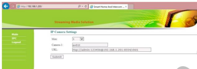
Количество: максимальное количество IP камер которые будут отображаться в интерфейсе внутреннего монитора.
