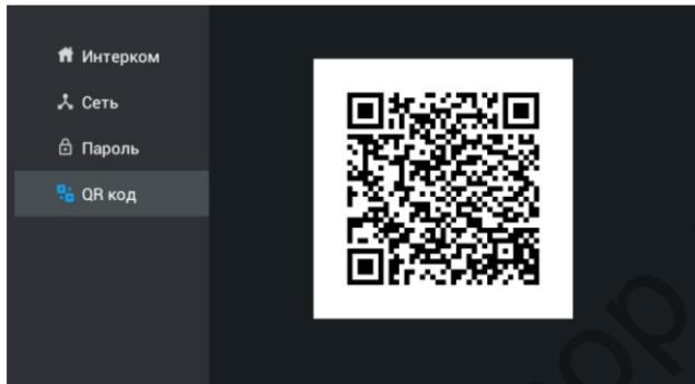
При использовании мобильного приложения на операционных системах iOS или Android, можно считать с помощью мобильного телефона данный QR код с экрана внутреннего монитора. При этом все настройки логического адреса в приложении на мобильном телефоне будут заполнены автоматически.
