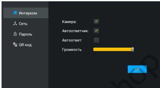
Камера: Включение или отключение встроенной камеры в мониторе при вызовах.
