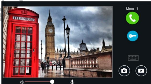
Нажмите кнопку «Снять трубку» для ответа на звонок, а кнопку «Отбой» для завершения вызова. Для открытия двери нажмите кнопку «Открыть замок». При входящем вызове автоматически сохраняется 1 фотография в памяти внутреннего монитора. Во время разговора с посетителем, нажатие на кнопку «Фото» сохраняет текущее изображение в память внутреннего монитора. Для записи видео нажмите кнопку «Видео», а нажатие на кнопку «Микрофон» отключает встроенный микрофон.
