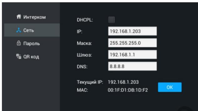
DHCP: Включение или отключение получения IP адреса от сервера DHCP.
