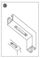
Установите монтажную планку для полых металлических каркасов
