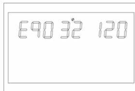
Рисунок 1-42 Сторінка налаштування часу затримки вирівнювання
