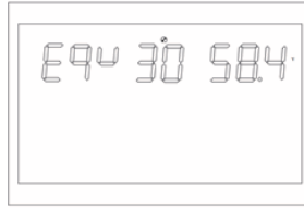
Рисунок 1-40 Сторінка налаштування точки вирівнювання напруги
