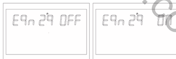
Рисунок 1-39 Сторінка налаштувань переходу інвертора в режим вирівнювання
