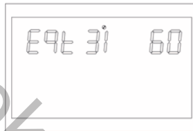
Рисунок 1-41 Налаштування часу вирівнювального заряду
