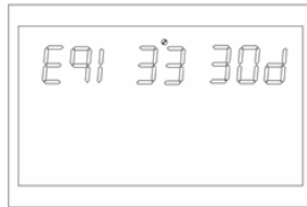
Рисунок 1-43 Налаштування інтервалу вирівнювання
