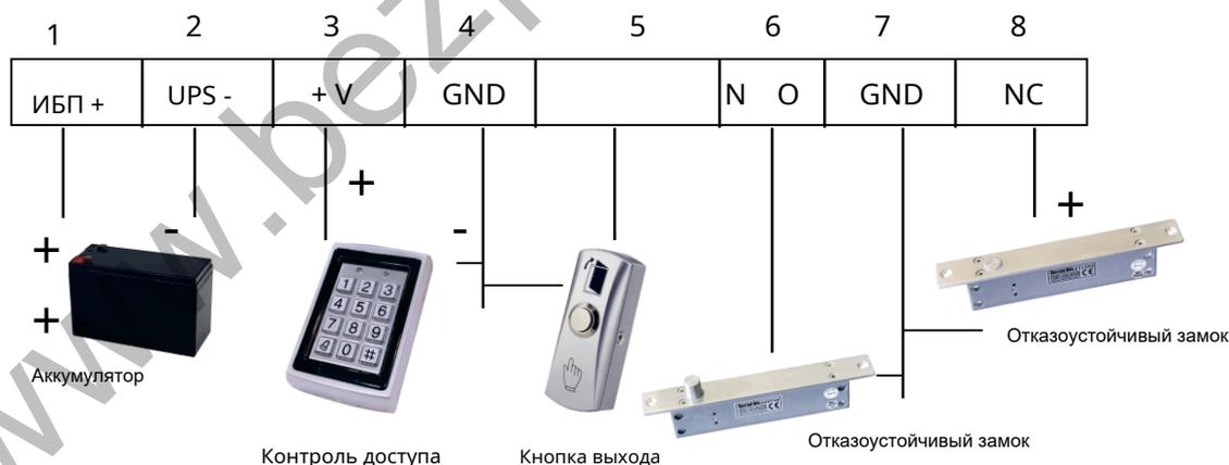
1-2: ИБП +: положительный электрод, ИБП -: отрицательный электрод.
