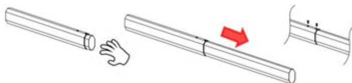
Малюнок 1 З'єднайте основну стрілу з другорядним важелем за допомогою 2 гвинтів
