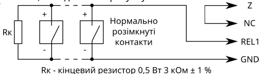
Рисунок 2.4 – Схема включення двопровідних сповіщувачів з нормально розімкнутими контактами
