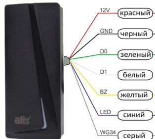
**Для смены битности считывания с Wiegand 26 на Wiegand 34 необходимо в обесточенном состоянии соединить провод WG34 и GND. Если этот провод не задействован - он должен быть надежно изолирован.**
