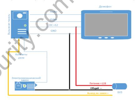
При подаче команды с домофона на открывание двери, контакты реле внутри панели замыкают цепь, и на замок поступает мощный электрический импульс, энергии которого достаточно для срабатывания механизма замка.
