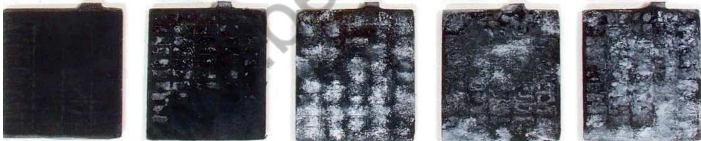
При работе АКБ в цикле Разрядки на пластинах аккумулятора образуется налет белого или бело-коричневого цвета – это кристаллы сульфата свинца. Образование этих кристаллов — нормальный процесс, возникающий при эксплуатации АКБ. Во время разрядки они образуются, а во время зарядки — разрушаются/растворяются... но есть много НО...
