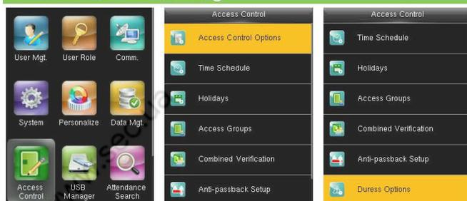
Нажмите М / ОК> Контроль доступа, чтобы войти в интерфейс контроля доступа.
