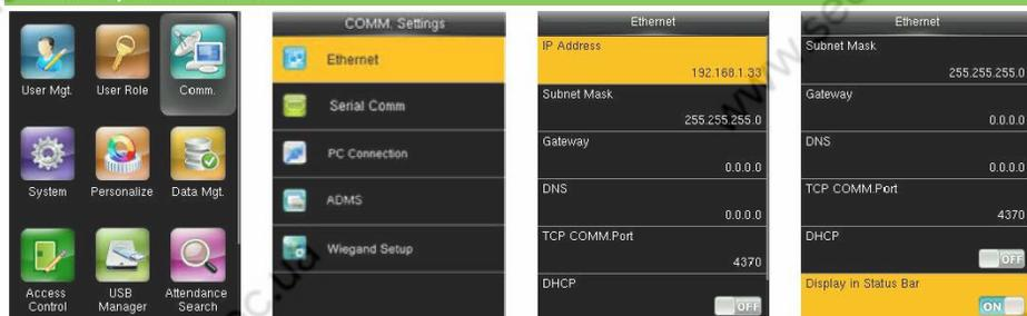
Нажмите М / ОК> Связь. > Ethernet для входа в интерфейс Ethernet.
