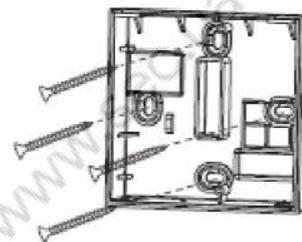
3. Закріпіть задню кришку на стіні. (Просвердлите отвір для кабелю і монтажні отвори для кріплення, відповідно до отворів
