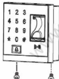
4. Закріпіть пристрій на задній кришці за допомогою гвинтів.
