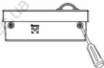
1. Видаліть гвинт з нижньої частини пристрою
