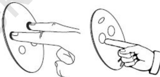
7. После записи всех необходимых брелков в память радиоприемника нажать одновременно кнопки <+> и <-> два раза.
