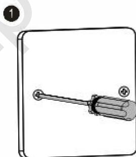
Открутите винты установленной на стене лицевой панели (тип 86).
