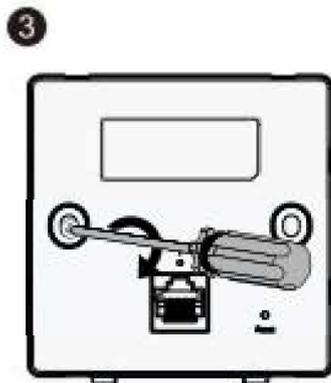
Совместите отверстия для винтов с обеих сторон устройства с отверстиями на лицевой панели. А затем закрутите винты отверткой.
