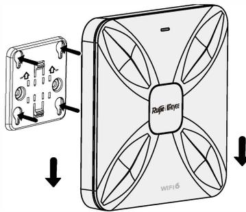
Соедините четыре «ножки» на задней стороне точки доступа с монтажными отверстиями на кронштейне.
