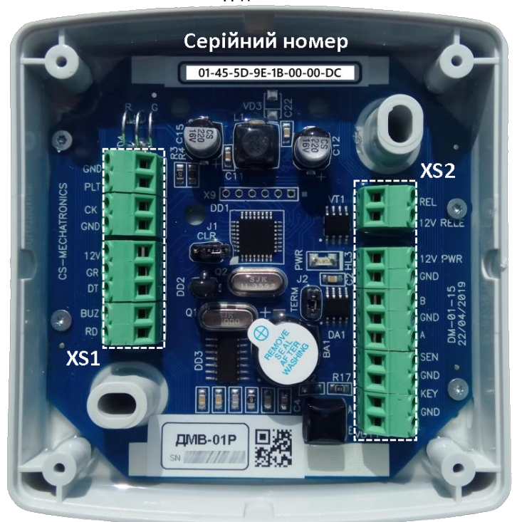
Рисунок А.1 - Елементи ДМП-01, які використовуються при підключенні і експлуатації.
