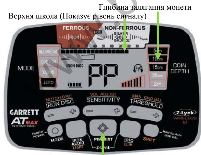
Глибина залягання монети Верхня шкала (Показує рівень сигналу) Кнопка PINPOINT (натисніть і утримуйте) ділянці.
