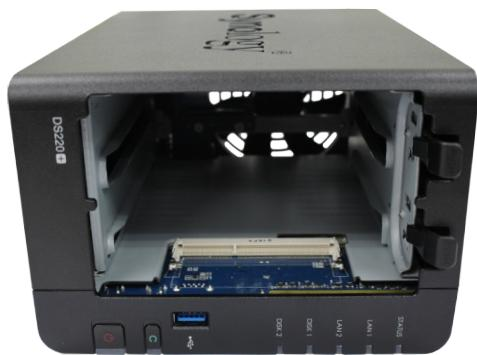
**Примечание.** После снятия лотков для дисков чувствительные внутренние компоненты остаются без защиты от внешних воздействий. Не трогайте внутренние компоненты, кроме блока памяти при его извлечении или установке.
