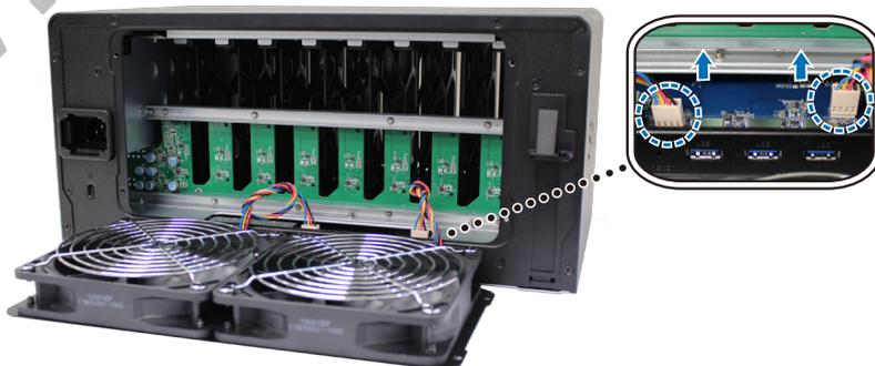
с Выкрутите винты, с помощью которых вентилятор крепится к корпусу вентилятора.
