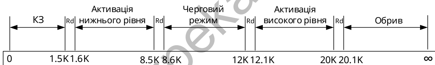
Рисунок 6 – Графік значення опору лінії відповідно до стану пристрою
