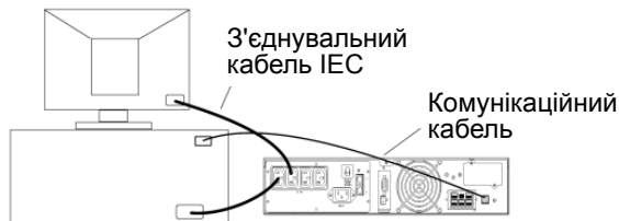
Мал. 5. Приклад підключення пристроїв Plug & Play
