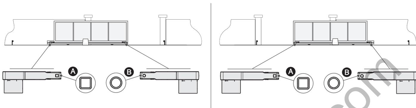
Следующие чертежи относятся к концевым выключателям, установленным с автоматикой, расположенной слева. Установка концевых выключателей справа является симметричной.
