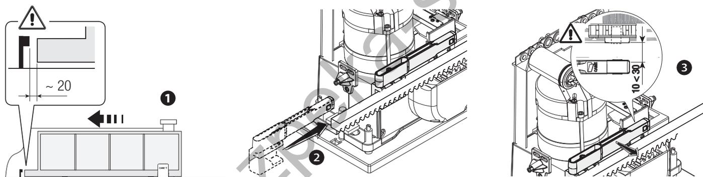
Прикрепите держатель к зубчатой рейке стопорными винтами (входят в комплект).
