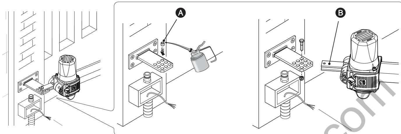
Відкрийте ворота, вставте стрижень у отвір кронштейну крінлення приводу до стулки й зафіксуйте його за допомогою шайби та гайки, що додаються у комплекті.
