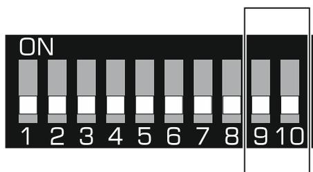
Рис. 2. Переключатели для определения режима работы контроллера.
