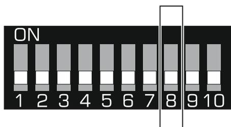
Рис. 3. Переключатель, позволяющий выбрать антенну для отправки сигналов.
