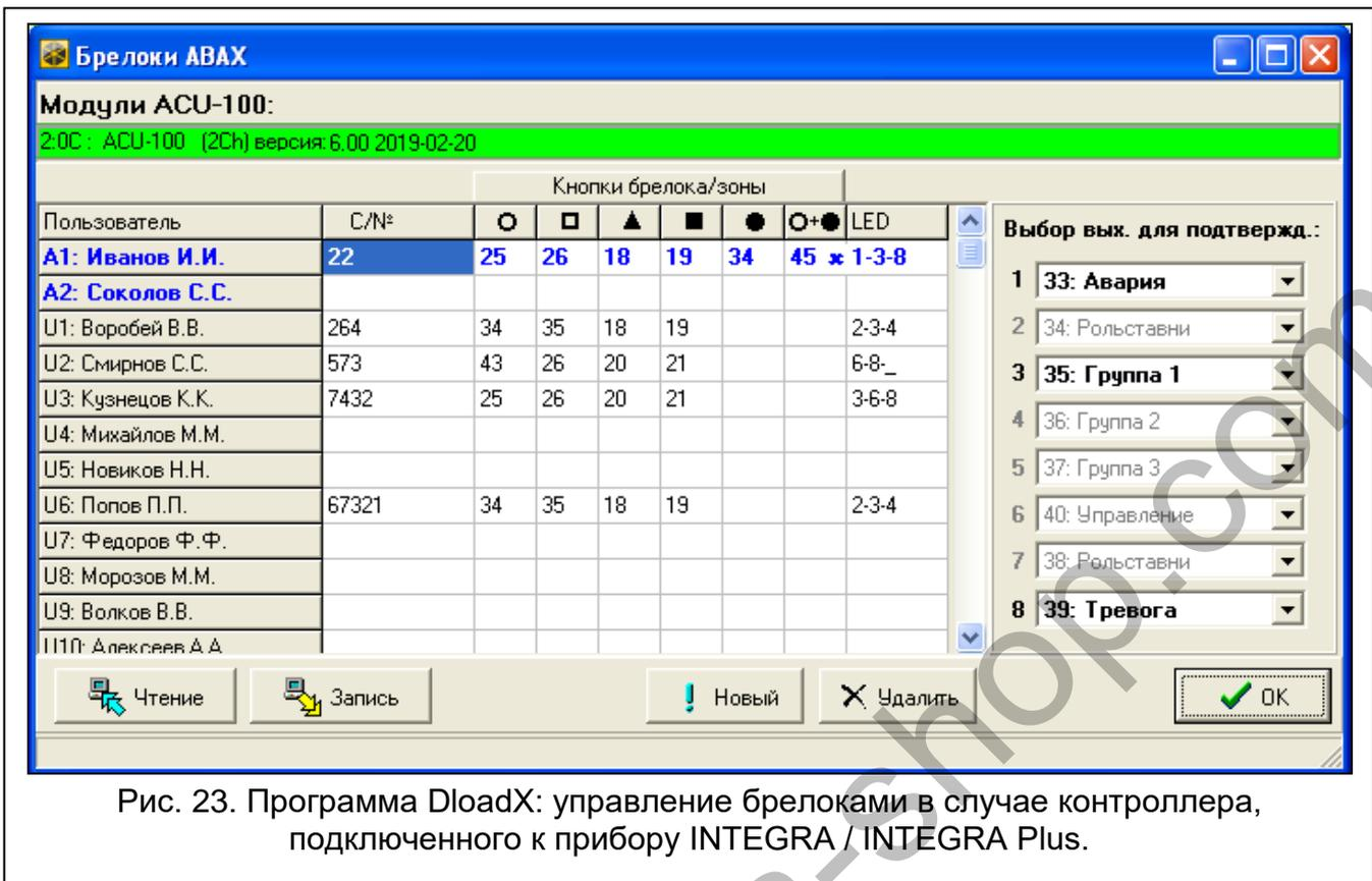
Рис. 23. Программа DloadX: управление брелоками в случае контроллера, подключенного к прибору INTEGRA / INTEGRA Plus.
