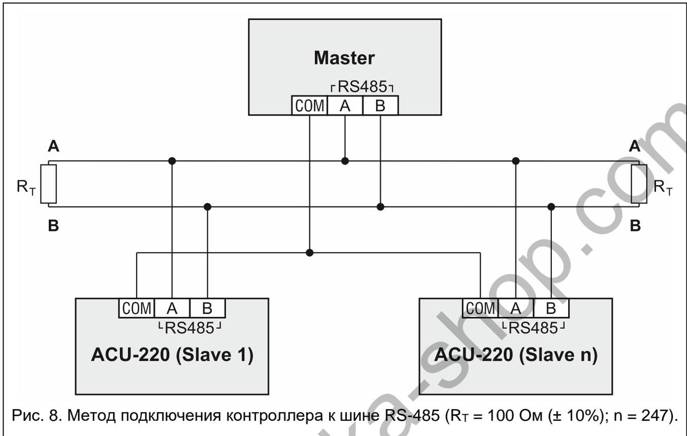
Рис. 8. Метод подключения контроллера к шине RS-485 ( $R_T = 100 \text{ Ом} (\pm 10\%)$ ;  $n = 247$ ).
