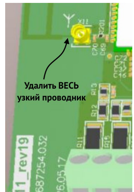
Рисунок 6. Подготовка платы ревизии 19 для подключения внешней антенны
