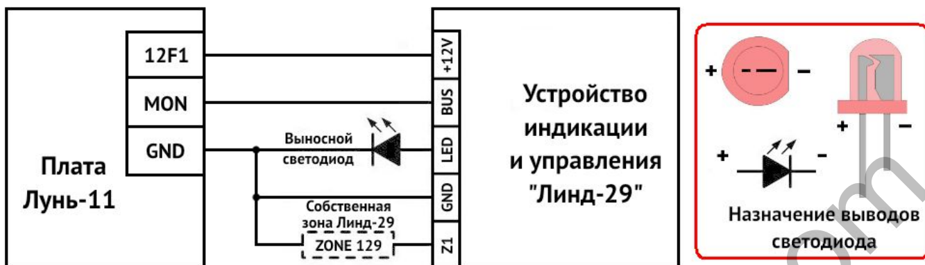
Рисунок 5. Схема подключения УИУ к ППК «Лунь-11»
