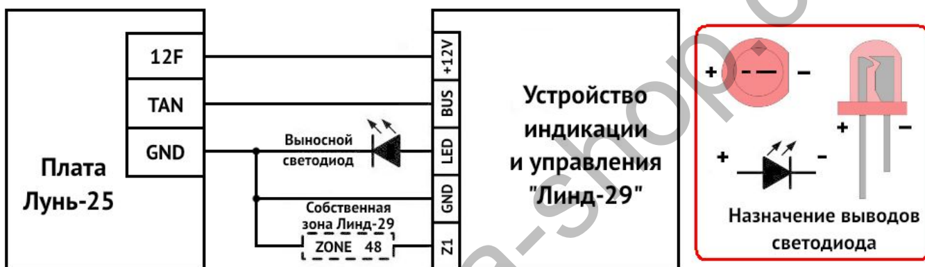
Рисунок 6. Схема подключения к ППК «Лунь-25»
