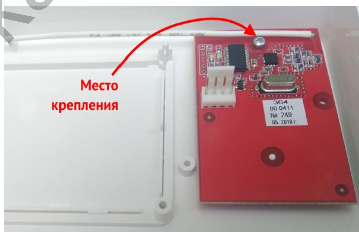
Рисунок 19. Радиоприемник «Lun RKI v3» в корпусе ППКОП
