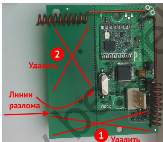
Рисунок 20. Подготовка радиоприемника Ajax «uartBridge»
