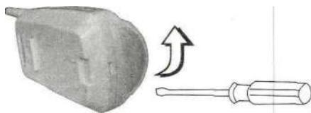
A. Нажмите слегка на защелку с помощью отвертки
