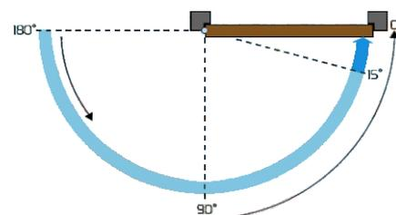
Доводчик имеет две независимые скорости: закрывания и дохлопа. Регулировки производятся соответствующими винтами на боковой грани.
