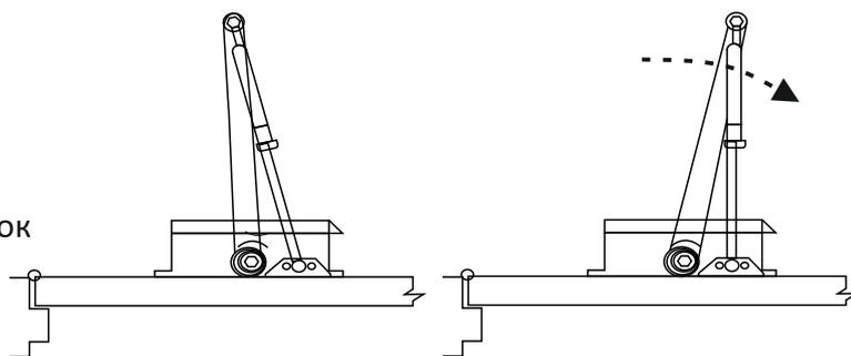
Таким образом, пружина доводчика изначально становится предварительно нагруженной, что увеличит усилие при полном закрывании двери. После регулировки этого «треугольника» собирается шарнир между рычагом и тягой доводчика.
