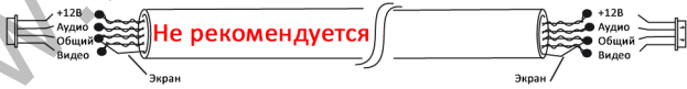
Не рекомендуется Экранированный кабель "витая пара" с подключенным экраном 4x2x0,50 (FTP-cat 5E) - дальность ~40м.
