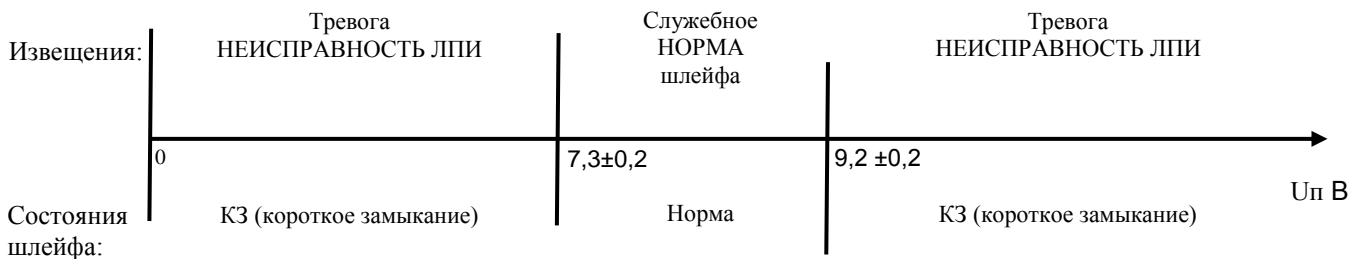
Рисунок Д.2 – Структура шлейфа контроля ЛПИ
