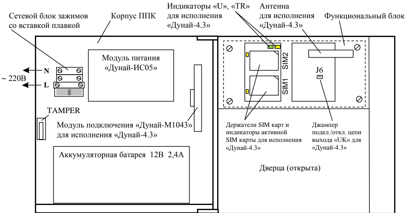
Рисунок Б.1 – Размещение модулей в ППК
