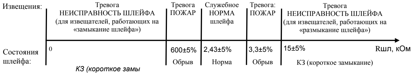
Рисунок Д.1 – Диаграмма формирования извещений при изменении сопротивления пожарного шлейфа
